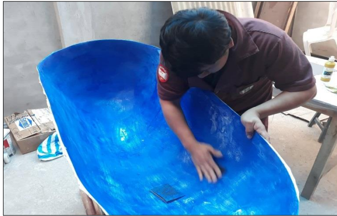
Figura 15-4: Proceso de lijado y masillado del molde.
