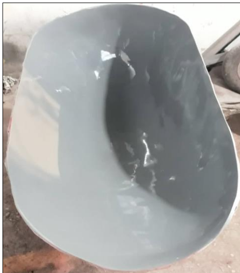
Figura 16-4: Molde en fibra de vidrio para la matriz de la cubierta del habitáculo.
