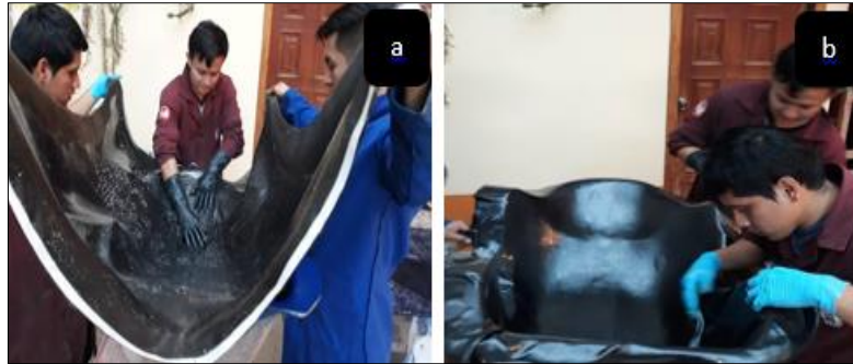
Figura 8-4: Aplicación de la fibra de carbono sobre el molde del asiento, b) Moldeado de la fibra de carbono.
