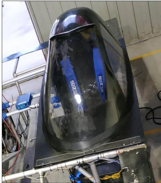
Figura 23-4: Instalación final de la cubierta del habitáculo.
