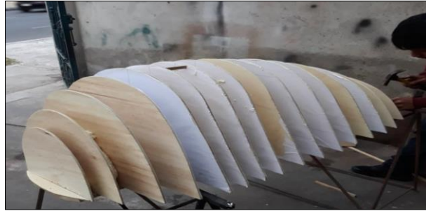
Figura 13-4: Proceso de manufactura del pre-molde de la cubierta del habitáculo.
