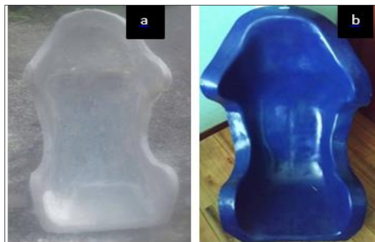
Figura 4-1: a) Superficie con capa de masilla automotriz, b) Superficie con fondo Automotriz.
