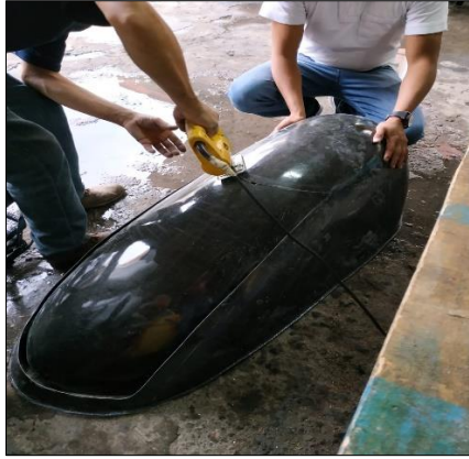
Figura 21-4: Mecanizado de las secciones para mejorar la visibilidad del piloto mediante una caladora.
