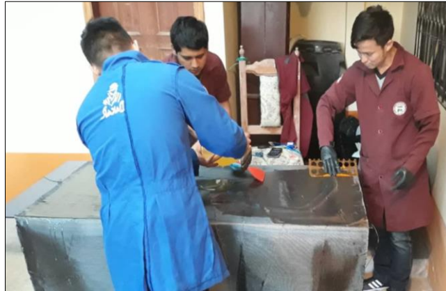
Figura 7-4: Saturación de la fibra de carbono.
