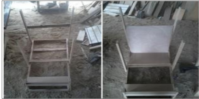
Figura 1-4: Mock-up para la construcción del molde en fibra de vidrio para el asiento.
