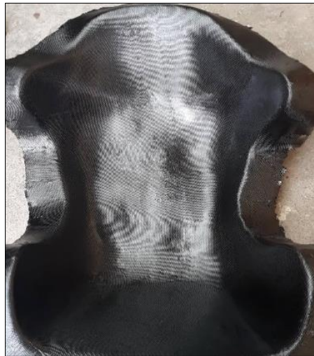
Figura 9-4: Secado de la fibra de carbono.
