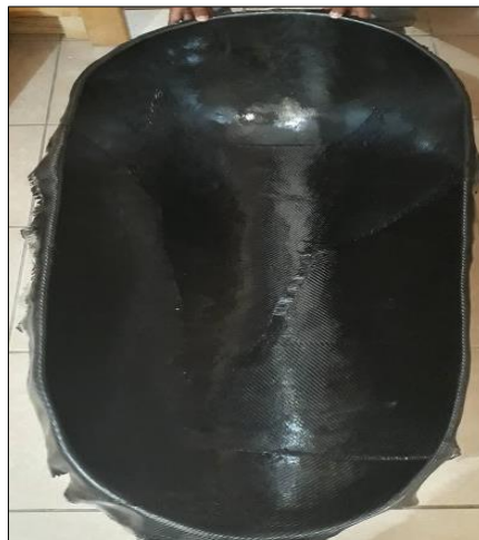
Figura 20-4: Curado de la fibra de carbono.
