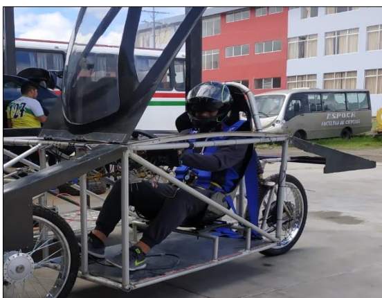
Figura 9-5: Ubicación del cinturón de seguridad de 4 puntos al chasis.
