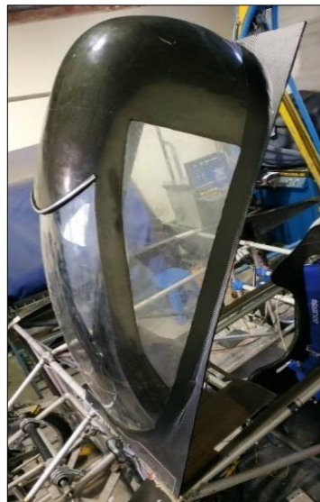
Figura 22-4: Mecanizado final de la cubierta del habitáculo.
