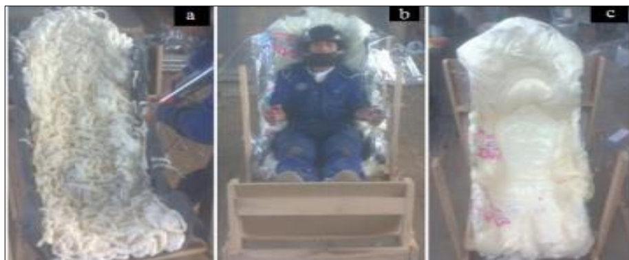
Figura 2-4: a) Relleno de espuma de poliuretano, b) Posición de confort del piloto, c)
