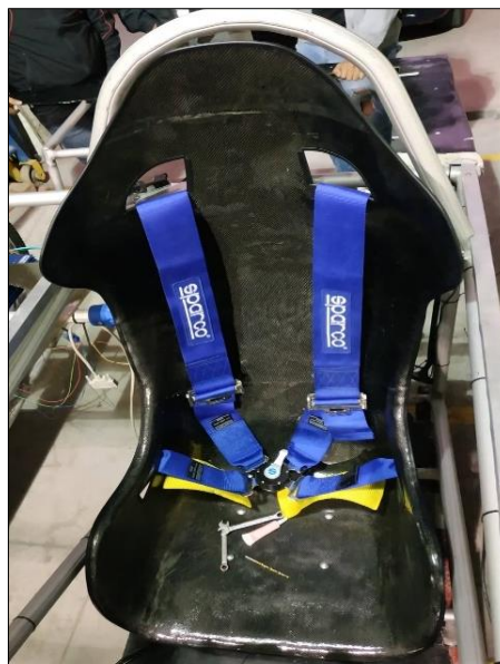
Figura 12-4: Instalación final del asiento ergonómico y cinturón de seguridad.
