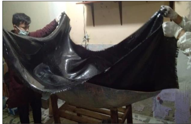
Figura 19-4: Aplicación de la fibra de carbono al molde de la cubierta del habitáculo.
